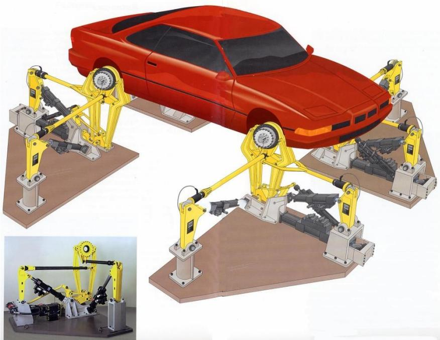
Figure N°1 : quatre simulateurs de route MTS Model 329
