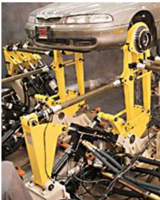
Figure N° 4 : Test d'un train roulant
