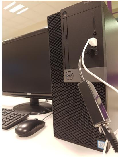
FIGURE 3 – Adaptateur réseau et câble USB coté ordinateur
