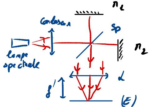
Le Michelson est réglé en lense d'air, donc les franges sont localisées à l'infini, donc dans le plan focal image d'une lentille convergente.
