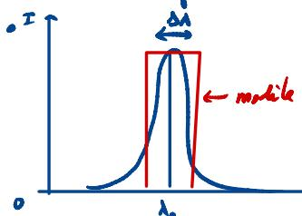
La largeur spectrale de la source peut-être vue comme une distribution uniforme. Ceci est équivalent à une source de source décentrée. La perte de contraste vient de l'intensité destructive des sources secondaires entre-elles.
