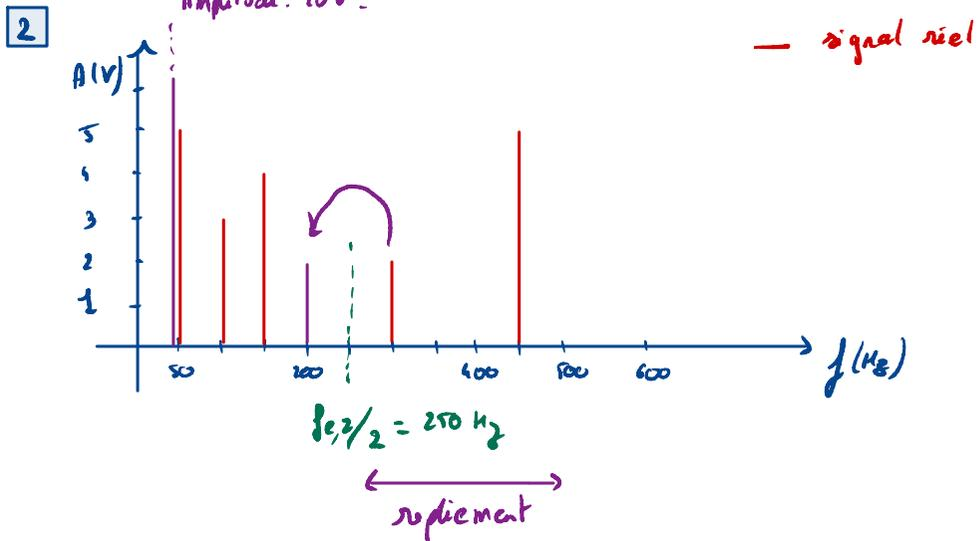
• Le repliement explique les 3 fréquences observées :
