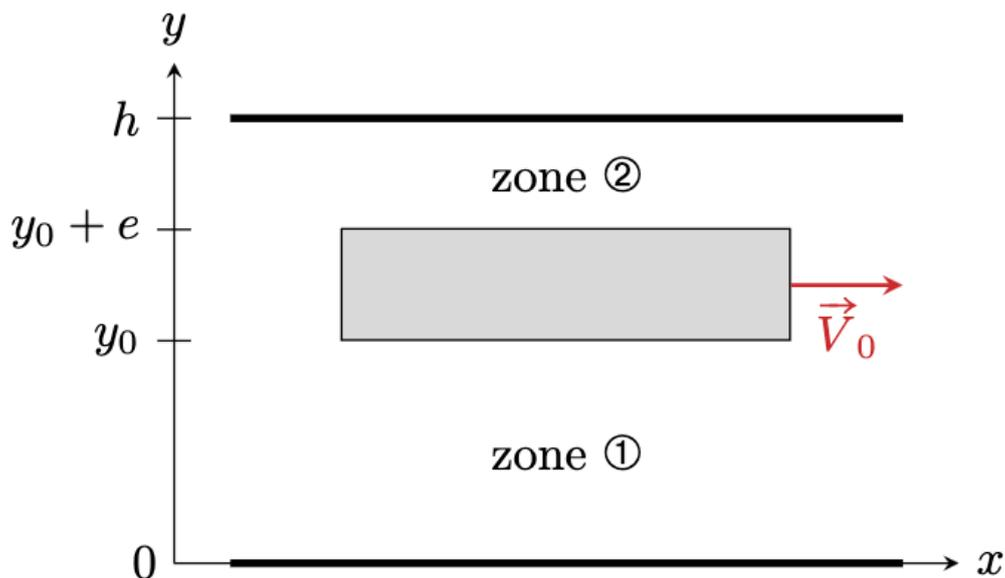
FIGURE 3 – Écoulement de Couette
