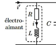
Un électroaimant de levage est un dispositif industriel permettant de soulever des pièces métalliques à partir de champs magnétiques intenses. On étudie un tel appareil en le modélisant électriquement par une bobine d'inductance  $L = 1,25$  H dont les spires ont une résistance interne  $R = 1 \Omega$ . Cette bobine est traversée par un courant  $i$  sinusoïdal de fréquence  $f = 50$  Hz dont l'amplitude  $I_m = 30$  A est imposée pour le bon fonctionnement du dispositif.
