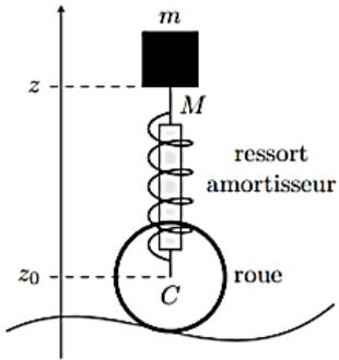
Le but de cet exercice est d'étudier les caractéristiques d'une suspension de VTT. Le VTT est modélisé par un solide de masse  $m$  décrivant le cadre et le vététiste, repéré par la position d'un point  $M$ , posé sur une unique suspension. L'effet de la roue arrière n'est pas pris en compte.
