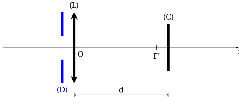
La distance  $d$  entre la lentille (L) et le capteur (C) est réglable, grâce à un mécanisme lié à l'objectif; elle est comprise entre  $d_{\min}$  et  $d_{\max}$ . À l'aide de cet appareil, on souhaite former sur le capteur l'image d'un arbre de hauteur  $h$  situé à une distance  $L$  devant l'objectif.
