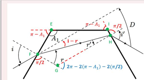
/1 schémas faisant apparaître l'angle  $\widehat{FGH}$  en prolongeant la normale au dioptre droit sur le dessin d'origine.
