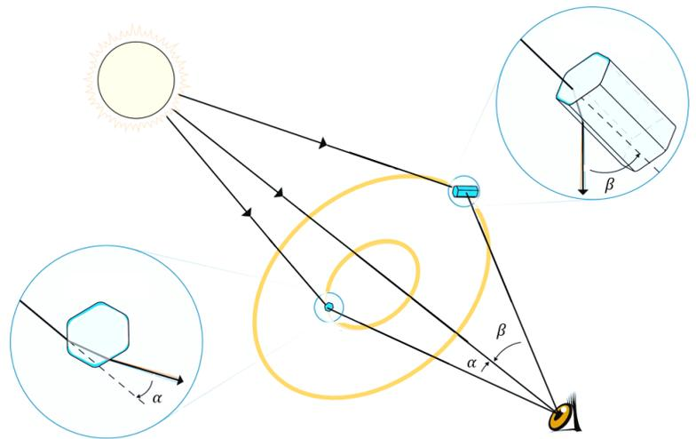
La figure (a) montre un rayon dévié par un cristal de section hexagonale régulière ( $A_1 = 120^\circ$ ) et la figure (b) envisage la déviation par un cristal dont deux faces adjacentes forment un angle  $A_2 = 90^\circ$ .
