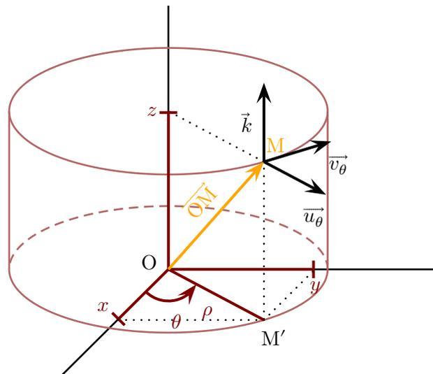
Figure XXXII.2 – Coordonnées cylindriques d'un point de l'espace.
