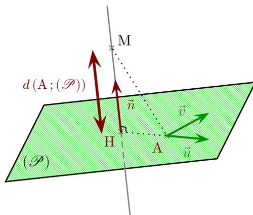
Figure XXXII.18 – Distance d'un point à un plan.
