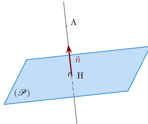
Figure XXXII.15 – H est le projeté orthogonal de A sur  $(\mathcal{P})$ .
