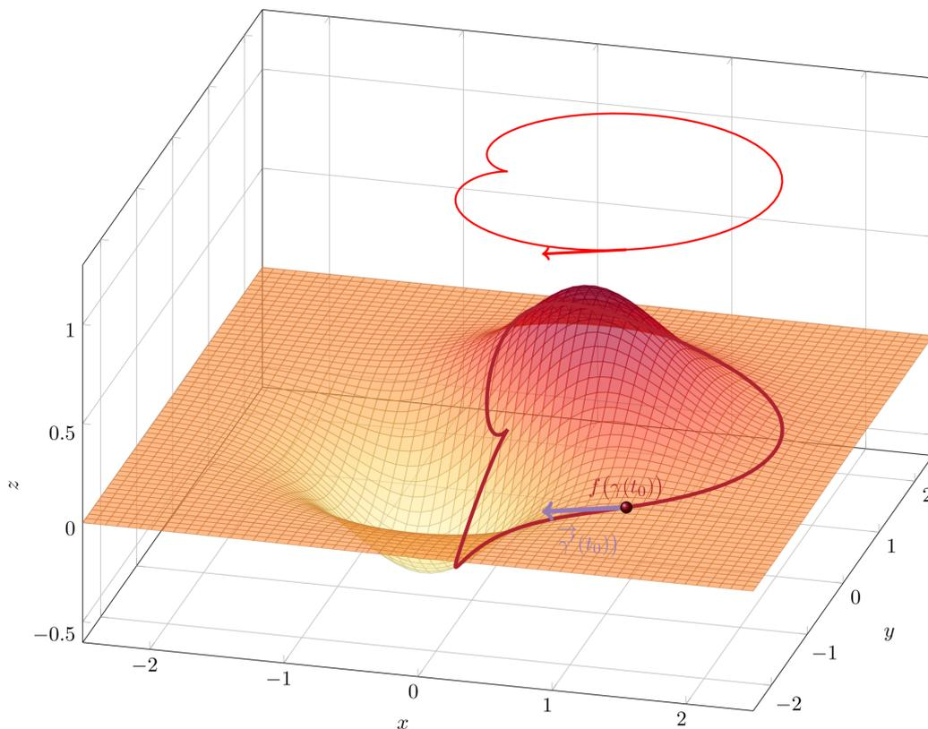
**Figure XXXIV.45** – Cardioïde d'équation  $\gamma : t \mapsto \begin{pmatrix} \cos(t)(1 + \cos(t)) \\ \sin(t)(1 + \cos(t)) \end{pmatrix}$
