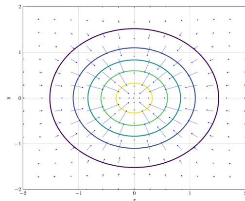
**Figure XXXIV.47** – Graphe de  $f : (x; y) \mapsto e^{-(x^2+y^2)}$ , son champ de gradients et quelques lignes de niveaux.
