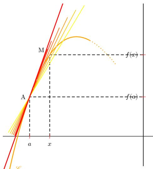
Figure IV.13 – Tangente à une courbe vue comme limite de ses sécantes.
