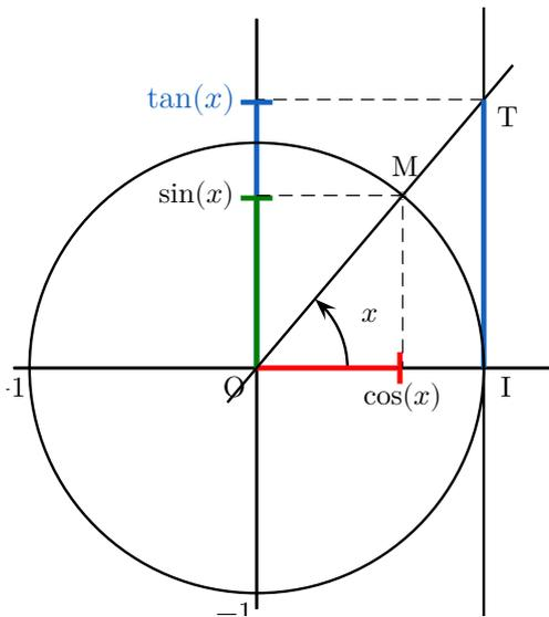
Lorsque  $x \neq \frac{\pi}{2} + k\pi$ , on note T l'intersection de (OM) avec la tangente au cercle en I(1,0).
