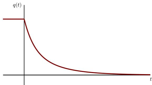
Figure XI.5 – Décharge aux bornes du condensateur d'un circuit RLC en régime aperiodique.
