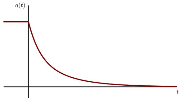
Figure XI.5 – Décharge aux bornes du condensateur d'un circuit RLC en régime apériodique.
