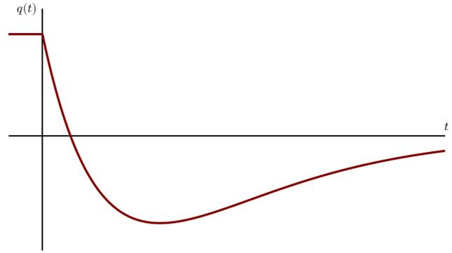
**Figure XI.7** – Décharge aux bornes du condensateur d'un circuit RLC en régime critique.
