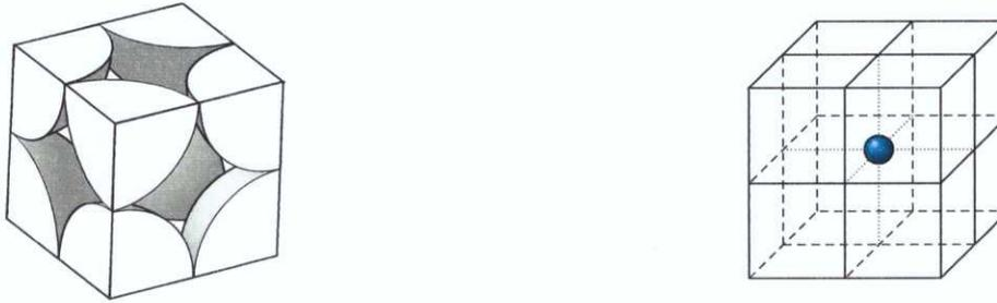
**Figure 7 – Atome au sommet d'un cube, partagé entre plusieurs mailles.** Figure de gauche : point de vue de la maille, seul un huitième de l'atome s'y trouve. Figure de droite : point de vue de l'atome, il appartient à huit mailles différentes.
