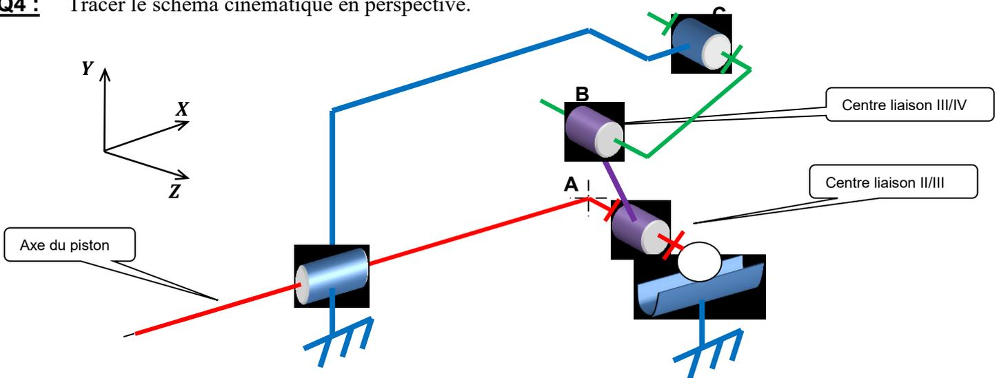
**Q5 :** Tracer les 2 autres positions : lorsque le papillon a tourné de  $30^\circ$  et  $90^\circ$  (vanne ouverte)
