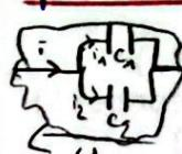
$$i = i_1 + i_2. \text{ où } i_1 = C_1 \frac{du}{dt} \text{ et } i_2 = C_2 \frac{du}{dt}$$
