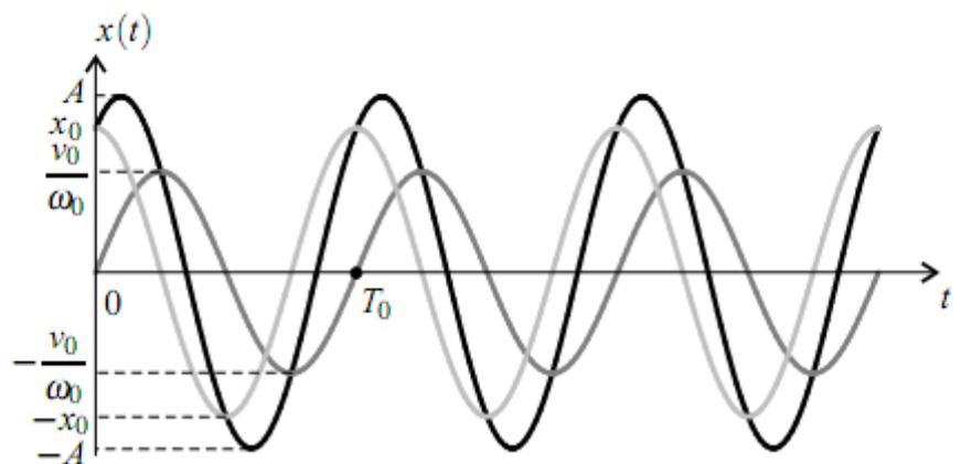
**Figure 1.2** – Représentation graphique de  $x(t)$  en fonction de  $t$ . En gris clair : cas  $x_0 \neq 0$  et  $v_0 = 0$ ; en gris foncé : cas  $x_0 = 0$  et  $v_0 \neq 0$ ; en noir : cas  $x_0 \neq 0$  et  $v_0 \neq 0$ . La période des oscillations est  $T_0 = \frac{2\pi}{\omega_0} = 2\pi\sqrt{\frac{m}{k}}$  (voir paragraphe 2).
