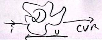
parcouru par le courant  $i(t) = I_m \cos(\omega t + \varphi_i) \sim \underline{i}(t) = I_m e^{j(\omega t + \varphi_i)} = I_m e^{j\varphi_i} e^{j\omega t} = \underline{I}_m e^{j\omega t}$
