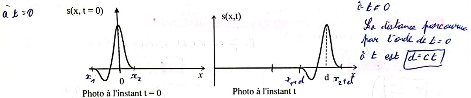
Figure 2.13 - Onde se propageant sans atténuation ni déformation dans le sens positif de (Ox), à deux instants différents.
