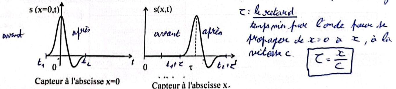
Figure 2.12 - Onde se propageant sans atténuation ni déformation dans le sens positif de  $(Ox)$ , en deux points différents.
