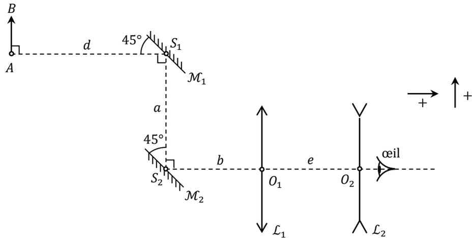
1. L'objet  $AB$  est placé à grande distance du périscope (suffisamment loin pour que  $d$  puisse être considéré comme infini). On note  $e_0$  la valeur de  $e$  permettant à l'œil d'observer  $AB$  à travers  $\mathcal{S}_p$  sans accommoder. Exprimer  $e_0$  en fonction des distances focales.
