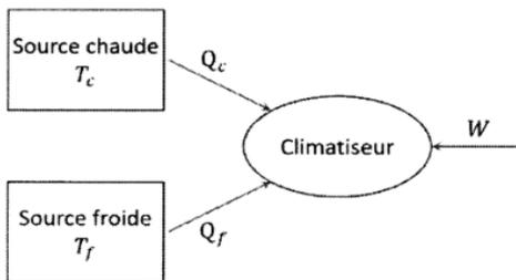
On s'intéresse désormais à un climatiseur ditherme, c'est-à-dire à une machine thermique cyclique capable de recevoir ou de fournir un travail, et d'échanger de l'énergie thermique avec deux thermostats aux températures  $T_f$  (pour la source « froide ») et  $T_c$  (pour la source « chaude »).
