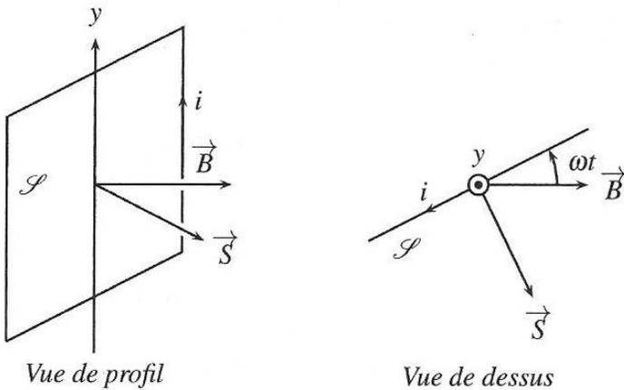
Figure 30.5 – Schéma de principe d'un alternateur.
