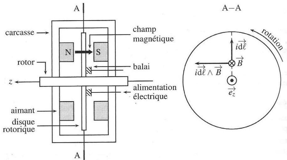
Figure 30.14 – Schéma d'une MCC à entrefer plan.
