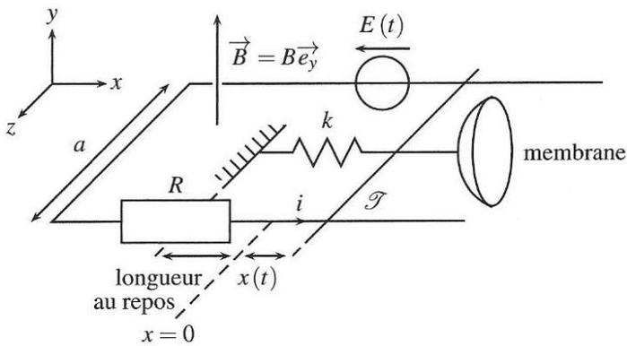
Figure 30.10 – Schéma de principe d'un haut-parleur.
