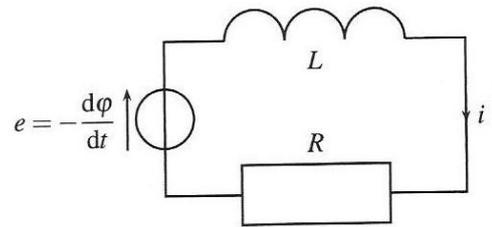
Figure 30.6 – Schéma électrique équivalent de l'alternateur.
