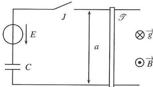
Une tige conductrice  $\mathcal{S}$  glisse sur deux rails horizontaux distants de  $a$ . Elle ferme électriquement un circuit comprenant un interrupteur  $J$ , un condensateur de capacité  $C$  et un générateur de f.é.m. constante  $E$ .  $\mathcal{S}$  a une résistance électrique  $R$  et une masse  $m$ . L'autoinductance du circuit sera négligée.
