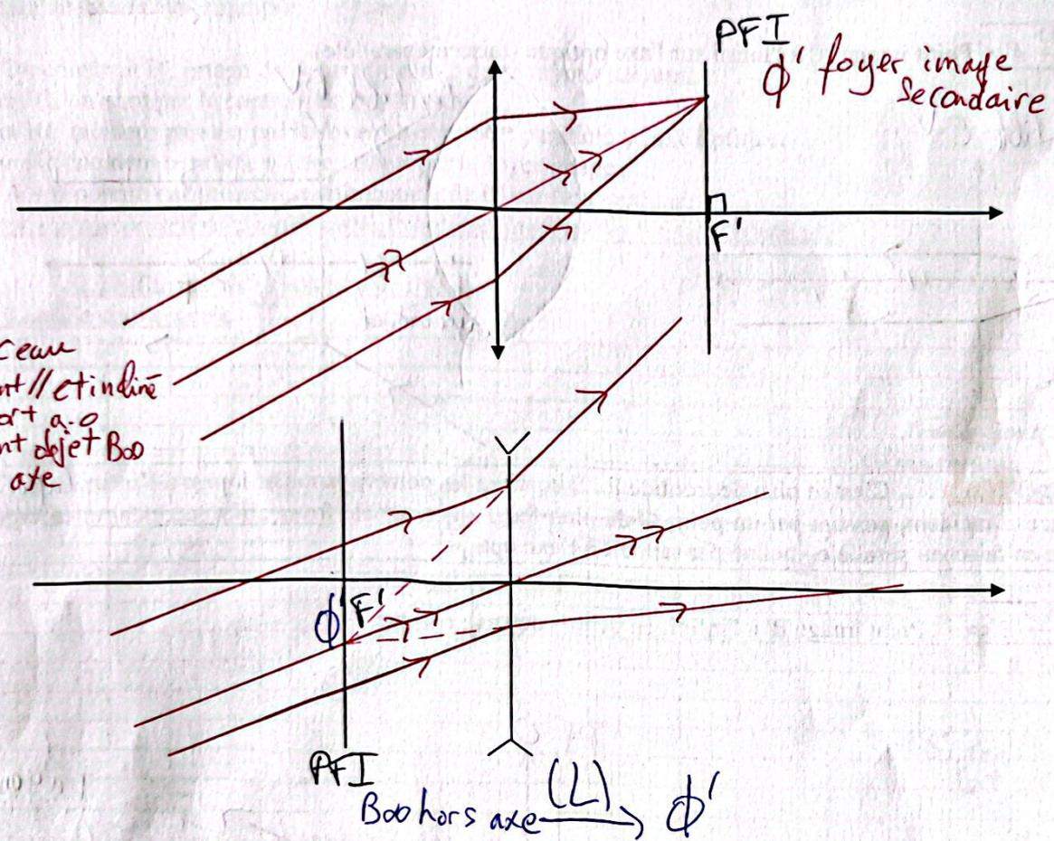
**Remarque :** Permet de construire le rayon émergent associé à tout rayon incident : on trace le rayon lumineux parallèle passant par le centre de la lentille. Il n'est pas dévié et coupe le plan focal image en  $\Phi'$ .
