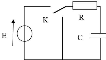
On utilise en général un GBF (générateur basses fréquences) avec un signal créneau, plutôt que d'utiliser un générateur continu avec un interrupteur.
