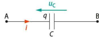
b) Puissance et énergie reçues :  $\mathcal{E}_C = \frac{1}{2} C u^2 = \frac{1}{2} \frac{q^2}{C}$
