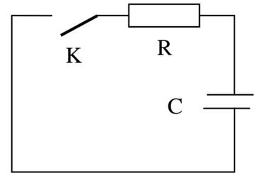
A  $t=0$ , on ferme l'interrupteur. Pour  $t>0$ , on cherche à observer l'évolution de la tension aux bornes du condensateur, ainsi que la charge portée par l'armature du condensateur, et l'intensité du courant circulant dans ce circuit.
