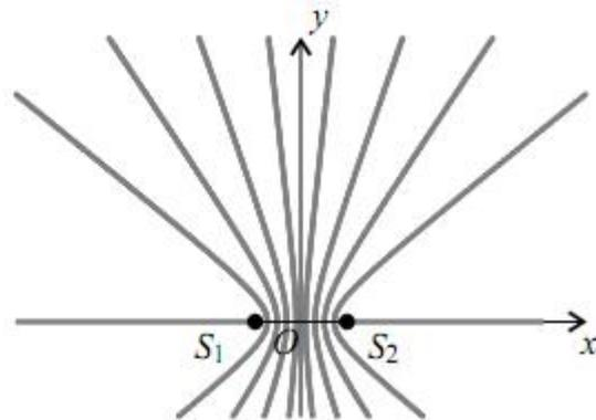
La figure ci-dessus représente une cuve à ondes éclairée en éclairage stroboscopique. Deux pointes distantes de  $a$  frappent en même temps, à intervalles réguliers, la surface de l'eau, générant deux ondes qui interfèrent. La figure est claire là où la surface de l'eau est convexe et foncée là où elle est concave. L'amplitude d'oscillation est plus faible là où la figure est moins contrastée.
