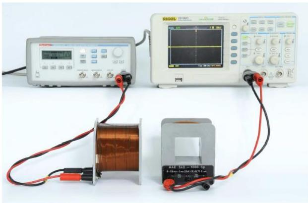
Si les axes des bobines sont perpendiculaires, on n'observe pas de tension induite.
