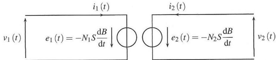
Figure 29.10 – Circuit électrique équivalent du transformateur.
