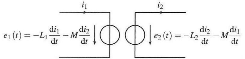
Figure 29.6 – Circuits électriques équivalents (convention générateur).
