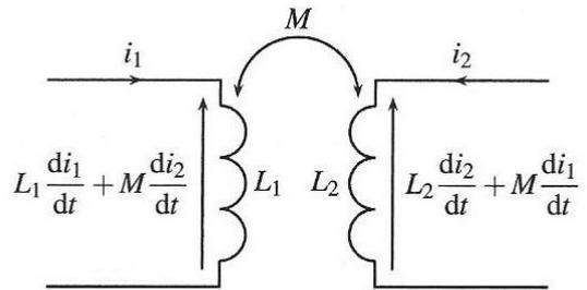
Figure 29.7 – Circuits électriques équivalents (convention récepteur).
