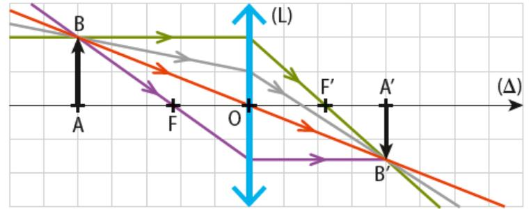
b. Le rayon incident parallèle à l'axe optique repère le foyer image  $F'$ , d'où l'on déduit  $f' = OF' = 1,1 \text{ cm}$ .
