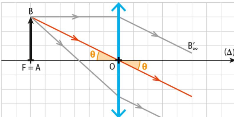
c. L'angle  $\theta$  sous lequel la portée est vue à travers la lentille vérifie  $\tan \theta = \frac{AB}{f'} = 0,10$  d'où  $\theta = \arctan(0,10) = 5,7^\circ$ .
