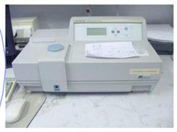
Soit un rayonnement monochromatique (de longueur d'onde  $\lambda$ ) d'intensité  $I_0$ , traversant une cuve de longueur lcontenant une solution d'une substance absorbante de concentration C. L'intensité du faisceau émergeant est I.
