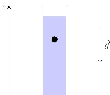
Si la bille est de rayon suffisamment petit par rapport au diamètre de l'éprouvette, la force de frottement exercée par le glycérol sur la bille est bien décrite par la loi de Stokes :
