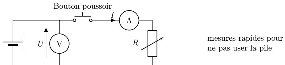
**E.4 Courant de court-circuit :** brancher directement l'ampèremètre pour mesurer  $I_0$  et  $u(I_0)$  lorsque  $U = 0$ .
