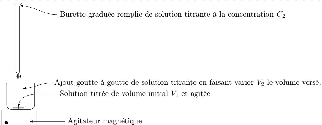
On prend  $V_1 = 10 \text{ mL}$  et  $C_2 = 0,5 \times 10^{-2} \text{ mol} \cdot \text{L}^{-1}$ . On désigne par  $V_2$  le volume de diiode versé.
