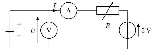
**E.2 Tension à vide :** brancher directement le voltmètre pour mesurer  $U_0$  et  $u(U_0)$  lorsque  $I = 0$ .
