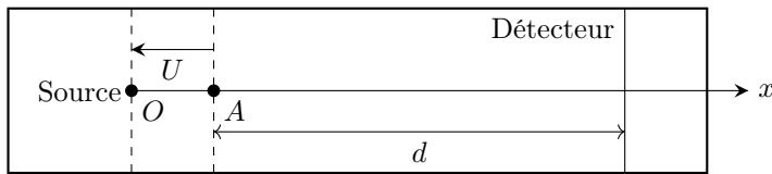
La source d'ions fournit des ions de masse  $m$  et de charge positive  $q$  qui entrent en  $O$  avec une vitesse négligeable dans une zone d'accélération (comprise entre  $O$  et  $A$ ) où une tension électrique  $U = 15\text{ kV}$  est appliquée. Les ions parcourent librement la région suivante jusqu'au détecteur situé à la distance  $d = 1,0\text{ m}$  de la zone d'accélération. On mesure le "temps de vol"  $t_v$  mis par la particule pour parcourir la distance  $d$ .
