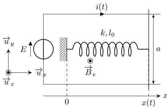
Le circuit constitué des rails et de la barre est alimenté par un générateur imposant une tension  $E(t)$ . La résistance totale du circuit, supposée constante, est notée  $R$ . Les propriétés électriques de la bobine du haut-parleur sont prises en compte sous la forme d'une inductance propre  $L$ , non négligeable.
