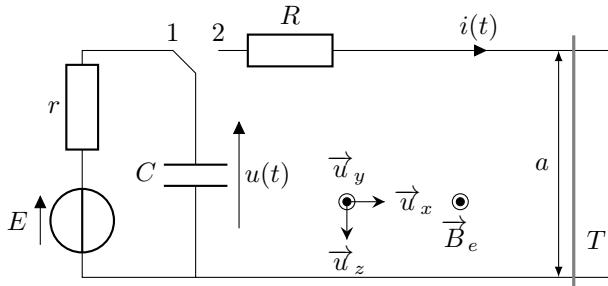
La tige conductrice  $T$  de masse  $m = 5,0 \text{ g}$  se déplace à la vitesse  $\vec{v}_0 = v_0 \vec{u}_x$ . Le champ magnétique uniforme et stationnaire  $\vec{B}_e = B_e \vec{u}_y$  est imposé, avec  $B_e = 50 \text{ mT}$ .
