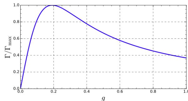
Couple moteur en fonction du glissement  $g = \frac{\omega_g}{\omega_s}$
