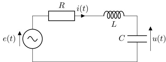
**Q.1** Exprimer l'impédance totale du circuit  $\underline{Z}_{\text{eq}}$  puis en déduire  $I_m(\omega)$  l'amplitude du courant.
