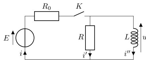
L'interrupteur est ouvert depuis longtemps. À  $t = 0$ , on ferme l'interrupteur.
