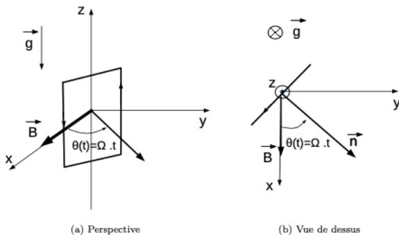
On considère une bobine plate à section carré de côté  $a$  et constitués de  $N$  spires : le rotor. Il est plongé dans un champ magnétique uniforme et stationnaire  $\vec{B} = B_0 \vec{u}_x$  et entraîné à la vitesse angulaire  $\Omega$  constante autour de l'axe  $Oz$ .
