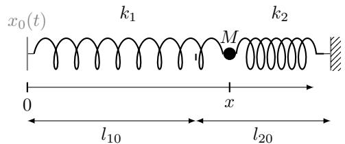
$M$  est relié à deux parois verticales par deux ressorts de raideurs  $k_1$  et  $k_2$ , de longueurs à vide  $l_{10}$  et  $l_{20}$ . Celle de droite est immobile en  $x = L$ , celle de gauche, d'abscisse  $x_0(t)$ , est animée d'un mouvement d'équation horaire  $x_0(t) = X_{0m} \cos(\omega t)$ . On supposera que  $L = l_{10} + l_{20}$ .
