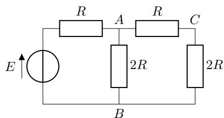
**Q.1** Calculer la résistance équivalente  $R_{AB}$  ( $R_2$ ,  $R_3$ ,  $R_4$ ) entre les points  $A$  et  $B$ .
