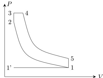
Au point 1 du cycle, la pression  $P_m = 1,0\text{ bar}$  et la température  $T_m = 293\text{ K}$  sont minimales. La pression maximale, aux points 3 et 4 vaut  $P_M = 60\text{ bar}$  et la température maximale, au point 4, vaut  $T_M = 2073\text{ K}$ . Le rapport volumétrique de compression vaut  $\beta = \frac{V_M}{V_m} = 17$ .
