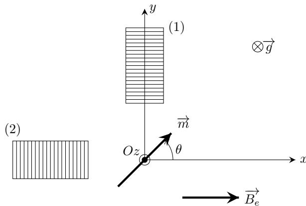
Son moment magnétique  $\vec{m}$  appartient au plan  $xOy$ ; il est repéré par l'angle  $\theta$ . L'aiguille est soumise à un champ magnétique uniforme et permanent  $\vec{B}_e = B_e \vec{u}_x$  avec  $B_e = 1,0\text{ mT}$ .
