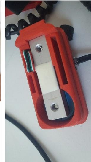
Capteur d'effort à jauge de déformation utilisé en flexion (sur Slider de caméra, même fonction sur la cordeuse)
