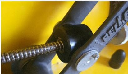
Vis à billes (liaison hélicoïdale réversible) du Maxpid
