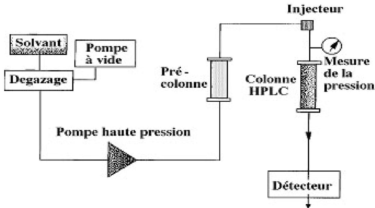
Le suiti de l'éluion des molécules d'intérêt peut être réalisé par différentes techniques : spectrophotométrie d'absorption moléculaire, fluorimétrie, réfractométrie, etc.
