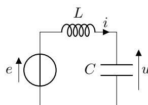
Alors que la tension délivrée par le générateur vaut  $e = 0 \text{ V}$  depuis longtemps, nous la bascurons sur la tension constante  $E$  à  $t = 0$ .
