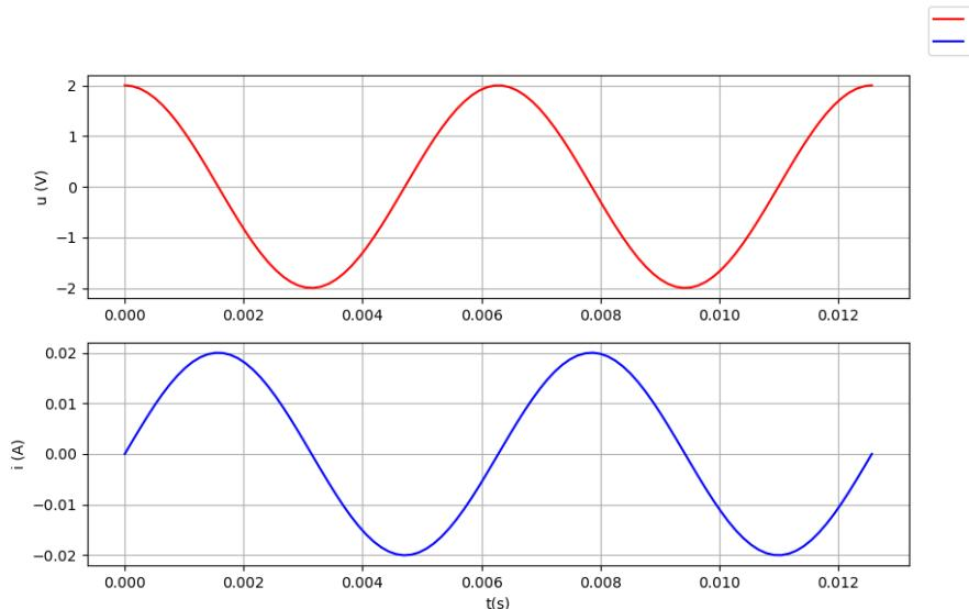
Tracé pour  $E = 2 \text{ V}$ ,  $C = 10 \times 10^{-6} \text{ F}$  et  $L = 100 \times 10^{-3} \text{ H}$ .
