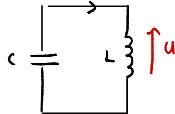
La tension aux bornes du condensateur est la même que celle aux bornes de la bobine (L).
