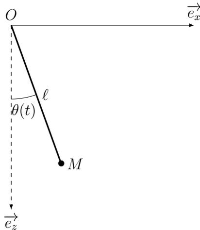
Nous étudions un pendule pesant simple de longueur fixe  $\ell$ , composé d'une tige de masse négligeable au bout de laquelle oscille une masse  $m$  supposée ponctuelle repérée par le point  $M$ .
