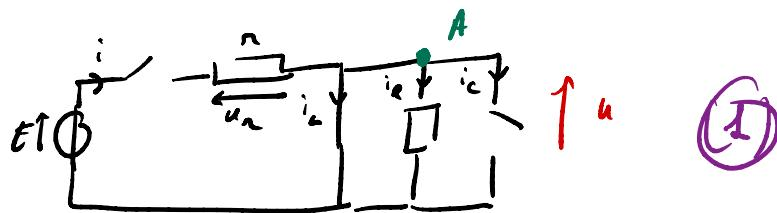
$u(0^-) = 0$  car tension aux bornes d'un fil. (1)
