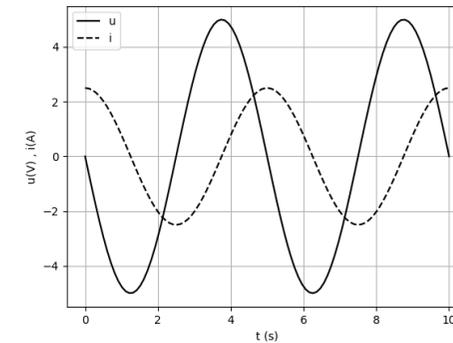
② Pour le condensateur, la tension est en retard de phase  $\pi/2$  par rapport au courant :
