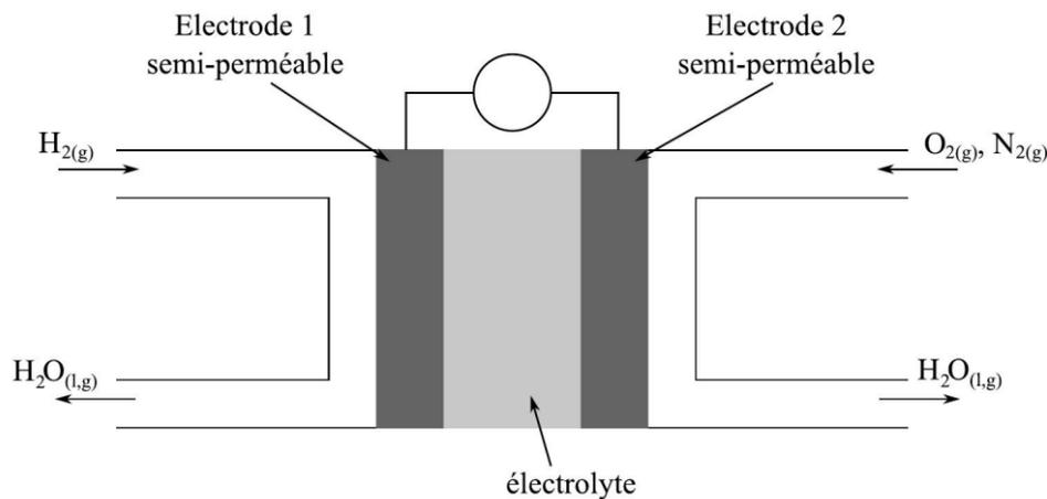
FIGURE 1 – Schéma d'une pile à combustible.
