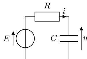
Données : à  $t > 0$ ,  $u(t) = E \left( 1 - \exp \frac{-t}{RC} \right)$  et  $i(t) = \frac{E}{R} \exp \frac{-t}{RC}$ .
