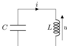
Données : à  $t > 0$ ,  $u(t) = E \cos(\omega_0 t)$  et  $i(t) = C\omega_0 E \sin(\omega_0 t)$  avec  $\omega_0^2 = \frac{1}{LC}$ .
