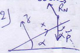
$$2^{\text{e}} \text{ loi de Newton: } m\vec{a} = \vec{P} + \vec{R}_N$$
