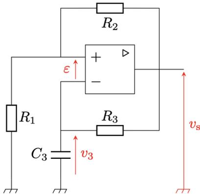
Dans le montage ci-contre, l'ALI idéal fonctionne en régime saturé. On note  $\varepsilon = v_+ - v_-$  la tension différentielle à l'entrée de l'ALI. On suppose qu'à  $t = 0$ , le condensateur  $C_3$  est déchargé et  $\varepsilon > 0$ . On pose
