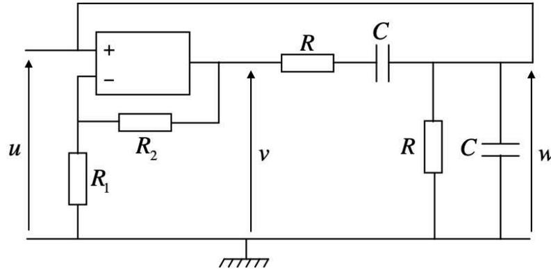
1. Donner la relation entre la tension de sortie  $v$  et la tension d'entrée  $u$  du montage à amplificateur opérationnel seul.
