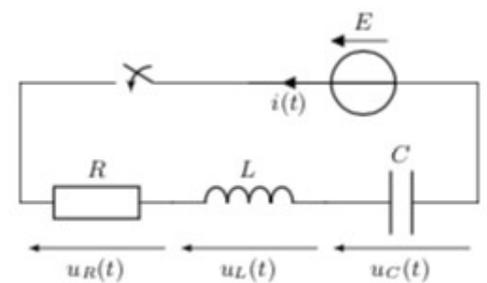
On suppose que dans la figure ci-contre, à  $t < 0$ , le condensateur est déchargé.
