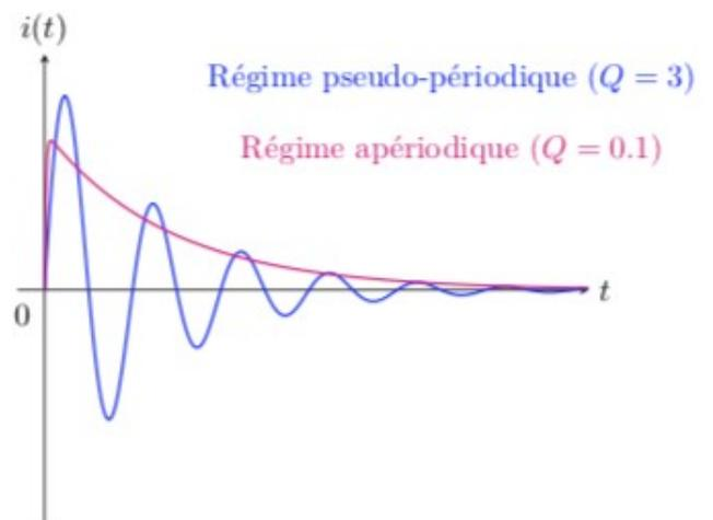
On peut donc faire varier les paramètres  $R$ ,  $L$  et  $C$  pour observer les différents régimes: la résistance est l'analogie du coefficient  $h$  pour les frottements fluides.
