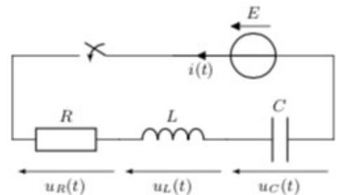
On étudie un circuit composé d'un condensateur de capacité C, d'une résistance R et d'une bobine d'inductance L en série branchés sur une alimentation idéale E que l'on éteint à  $t = 0$ . Avant l'extinction de l'alimentation, on est en régime permanent, donc le condensateur est équivalent à un interrupteur ouvert et la bobine à un fil.
