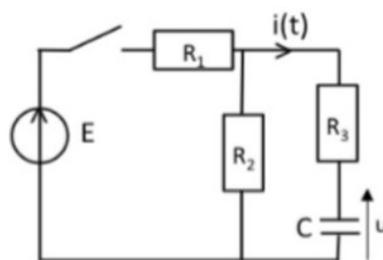
Déterminer  $i$  et  $u$  aux conditions aux limites  $t = 0^+$  et  $t \rightarrow +\infty$ , le circuit étant fermé à  $t = 0$ .
