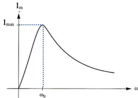
Tout se passe comme si l'inductance et le condensateur étaient absents : le générateur se comporte alors comme s'il était directement branché sur une résistance  $R$ . D'un point de vue pratique, la résonance peut poser des problèmes dans un circuit électrique vu l'intensité élevée circulant dans celui-ci.
