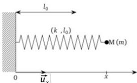
On considère le système constitué d'un ressort horizontal dont une extrémité est fixe dans le référentiel d'étude et l'autre est accrochée à une masse ponctuelle  $m$  astreinte à se déplacer selon un axe horizontal parallèle à l'axe  $Ox$ .
