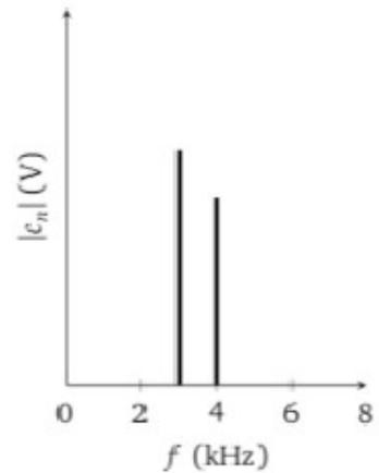
Spectre du signal  $e(t)$  après passage dans le second filtre
