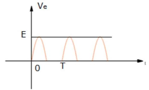
Le signal  $V_e(t)$  est envoyé sur un filtre de fonction de transfert complexe :  $H = \frac{0,5}{1+j\frac{\omega}{20}}$
