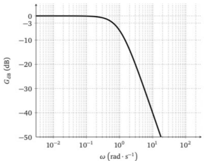
On envoie chacun de deux signaux carrés dans un filtre passe haut représenté ci-dessus. Déterminer qualitativement, le spectre de chaque signal en sortie. Même question si on envoie ces signaux dans le filtre passe-bas représenté ci-dessus.
