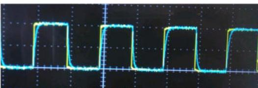
Cas 2 : La charge et décharge du condensateur est trop rapide, on remarque que les deux signaux sont trop proches l'un de l'autre. On ne peut pas observer correctement l'évolution de la charge et décharge. **La fréquence est trop faible.**
