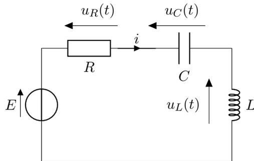
1.a – À  $t = 0^-$  on a  $i(0^-) = 0$  (car l'interrupteur est ouvert),  $u_C(0^-) = 0$  (car le condensateur est déchargé).
