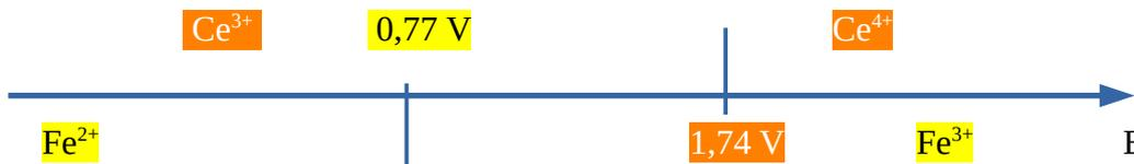
Si l'on introduit  $Ce^{4+}$  et  $Fe^{2+}$  dans la même solution, il n'existe pas de potentiel pour lequel les deux espèces puissent être en équilibre. Il y a donc réaction chimique :
